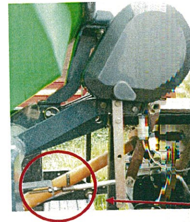
自動開閉式のシャッター機能は使わない。 手動式に改造する。 ロットを外して手動式のロットにつなぐ
