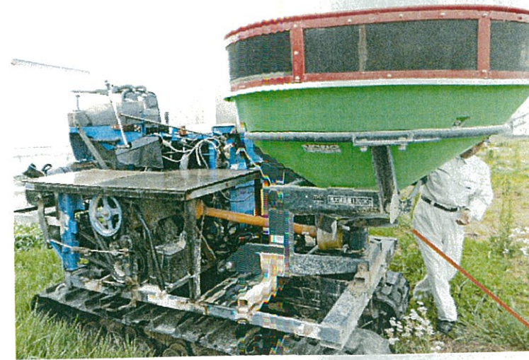
この写真は粉状貝化石を撒くために農家さんが1 tまではいるように改造したブロードキャスターです。
