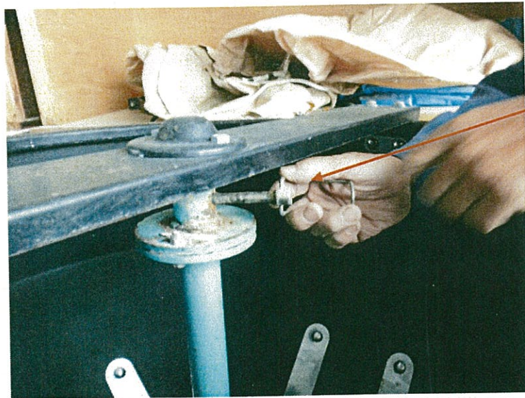
安全ピンを抜いて羽根が回らないようにする。
